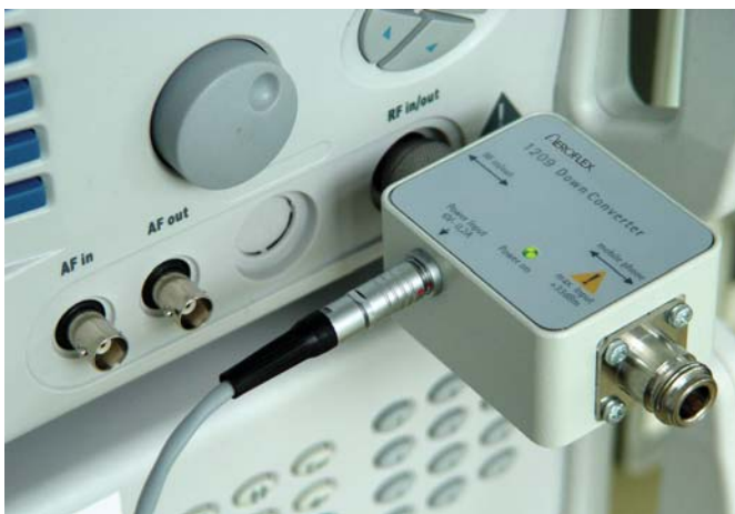
图 2: 1209 下转换器是用于蓝牙、WLAN、GPS测试和手机电视的可选频率扩展。
